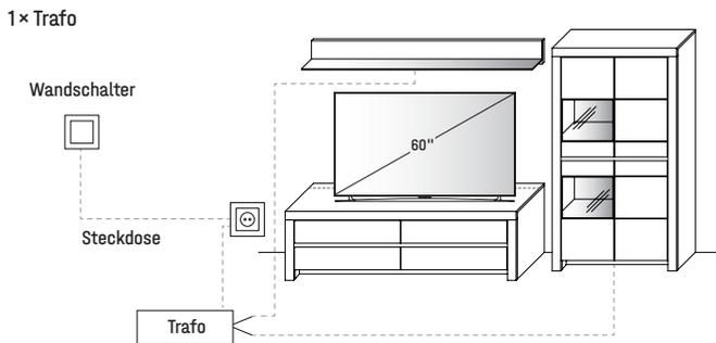
Bitte am Ende Ihrer Planung die Gesamtwattzahl ermitteln und den/die entsprechende(n) LED-Trafo(s) sowie die gewünschte Schaltervariante(n) definieren. Optional kann der Schalter durch einen Funkdimmer ersetzt werden, sodass Sie die Beleuchtung per Fernbedienung bequem vom Sofa aus steuern können. Diesbezüglich sollte dem Auftrag unbedingt eine Planungsskizze hinzugefügt werden.
